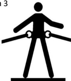
Arnés de cuerpo entero equipado con sistema para soportar al usuario en áreas de trabajo elevadas dispuestas de forma vertical, permitiendo el trabajo con las manos libres. “Las argollas laterales no deben ser usadas para detención de caídas y deben ser usadas en conjunto”.
