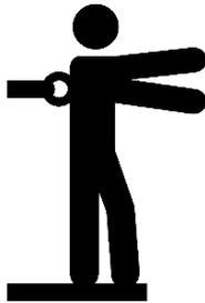
El arnés de cuerpo entero es usado como un componente de un sistema de restricción para prevenir que el usuario llegue a la zona de caída libre. Un sistema de restricción de caída debe incluir un arnés de cuerpo entero y una eslinga o línea de restricción.
