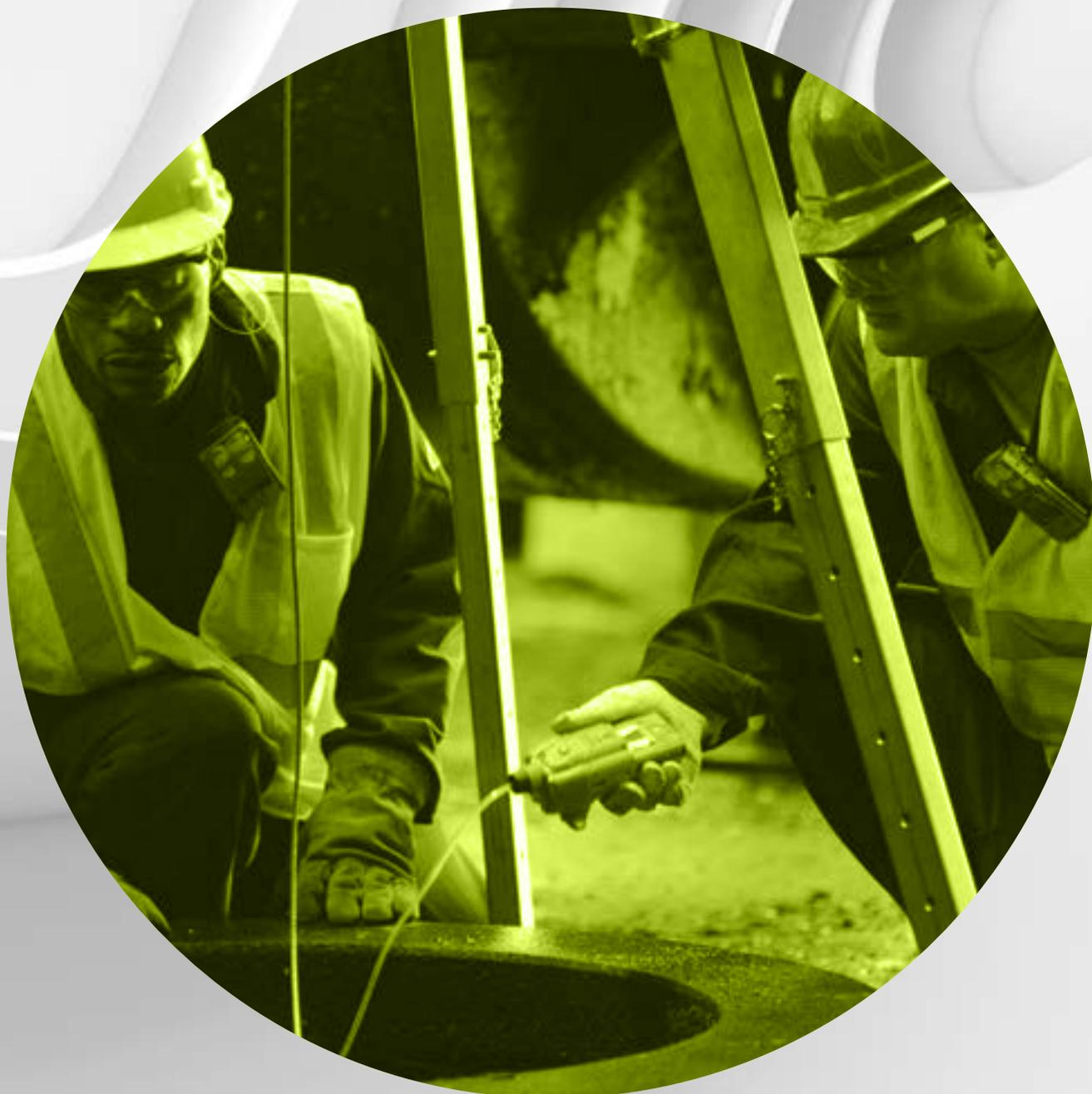
Un monitor de gases es un instrumento de lectura directa que mide las concentraciones en el aire de gases y vapores. Generalmente la concentración del agente químico es traducida a señales eléctricas que a su vez indican numéricamente en una pantalla de presentación el nivel existente o, a partir de ciertos valores, emiten señales de alarmas: ópticas, vibrantes y/o acústicas.
